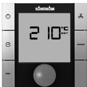
Параметр P36 = 0 «абсолютная» настройка заданной температуры
