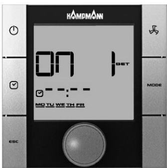
Режим ввода «Время включения»
