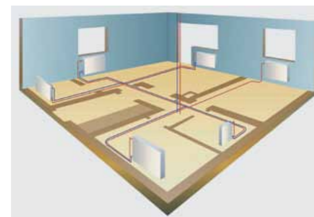
Рис. 40. Двухтрубная горизонтальная тупиковая схема
