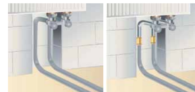
Рис. 49. Угловое непосредственное подключение
