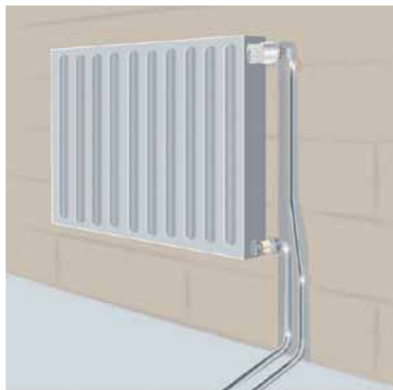
Рис. 43. Непосредственное подключение радиатора "из стены"
