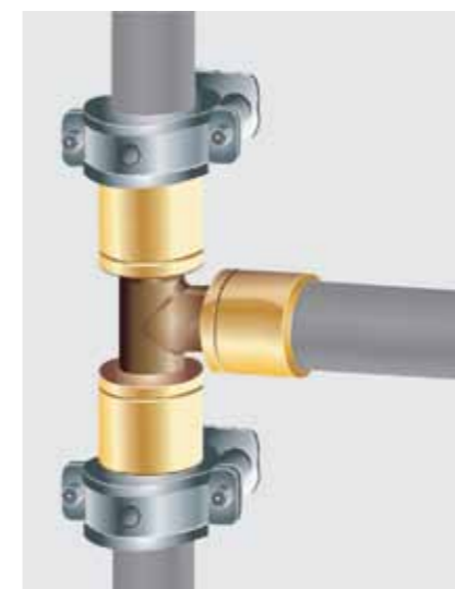
Рис. 26. Неподвижная опора с хомутами на тройнике
