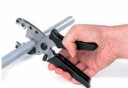
Рис. 11. Ножницы для резки труб
