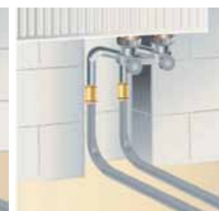
Рис. 50. Угловое подключение с комплектом Г-образных соединителей
