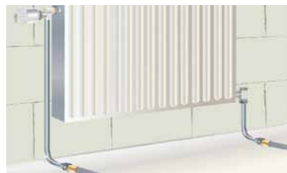
Рис. 45. Схема "сверху-вниз" (диагональное подключение). Рекомендуется для отопительных приборов большой длины
