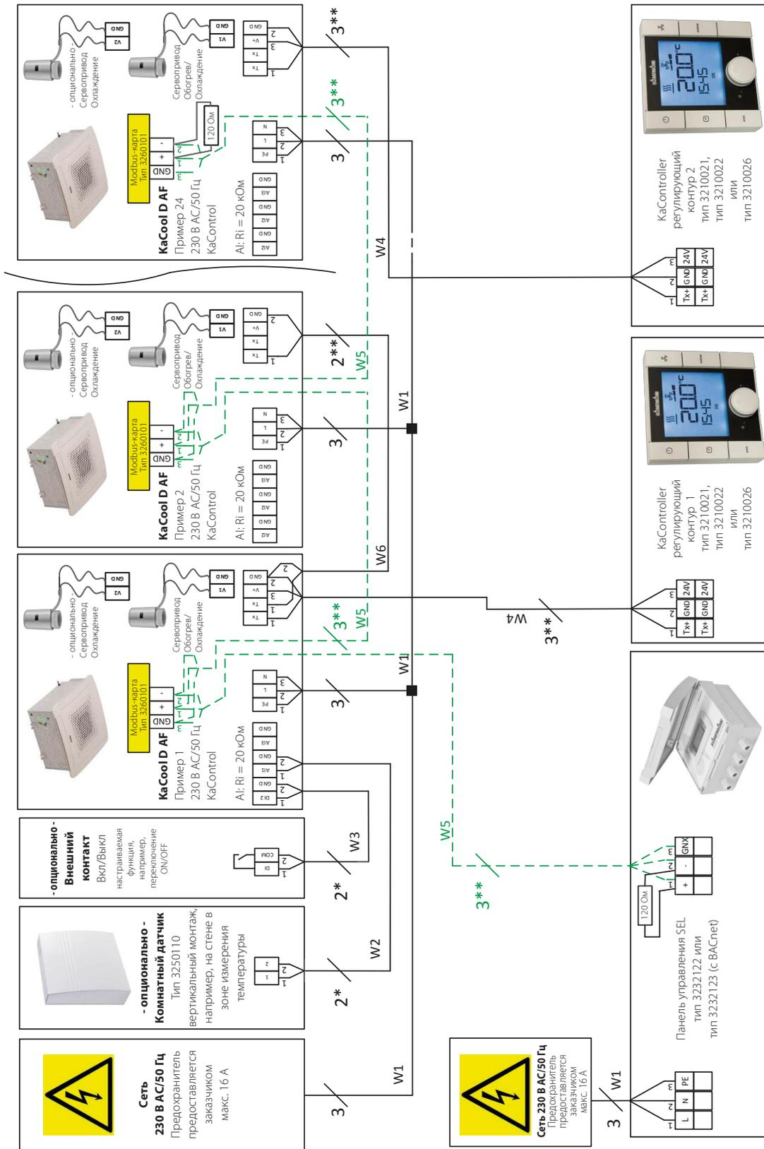
\*) Экранированный провод (например, NY(ST)Y, 0,8 мм) прокладывать отдельно от силовых линий.
