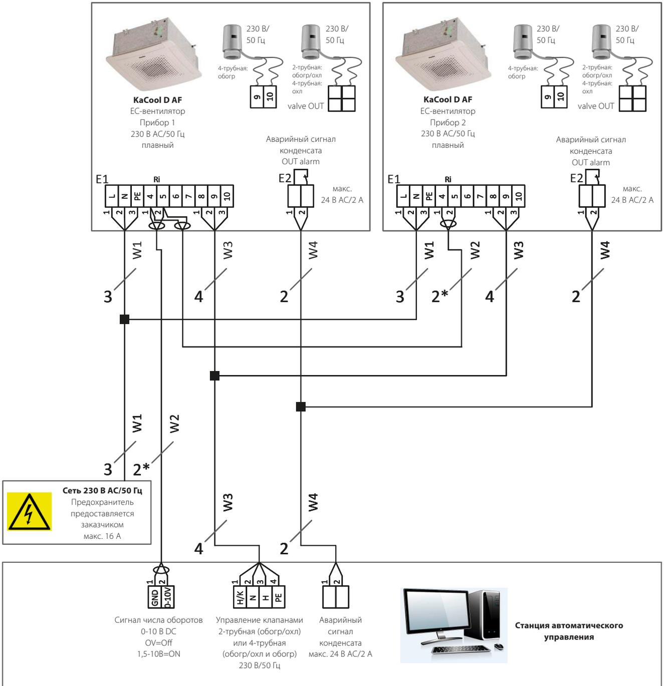
\*) Экранированный провод (например, IY(ST)Y, 0,8 мм) прокладывать отдельно от силовых линий.
