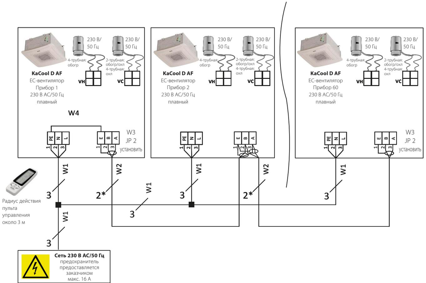
\*) Экранированный канал связи, попарно скрученный, например UNITRONIC® BUS LD 1 x 2 x 0.22 мм<sup>2</sup> или, по крайней мере, равнозначные, прокладывать линейно отдельно от силовых линий!
