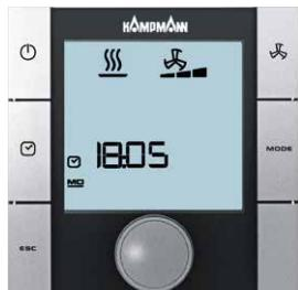
KaController позволяет контролировать работу подключенных внешних приборов независимо от программного обеспечения. Отдельные узлы конструкции, например, EC-вентиляторы, можно непосредственно активировать и контролировать путем ввода данных через KaController.
