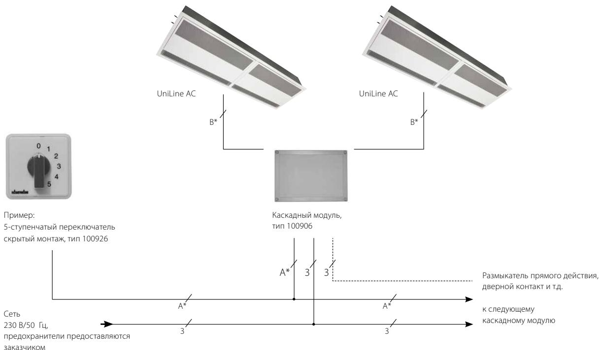
\* Количество жил кабеля, обозначенных буквами, см. в таблице ниже. Количество жил прочих кабелей, вкл. провод защитного заземления, указано непосредственно в схеме монтажа проводов. Значение, указанное в скобках, действительно при использовании термостата защиты от замораживания (необходим только при использовании в неотапливаемых помещениях).
