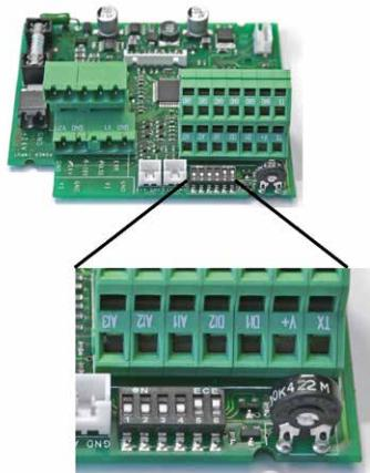
Настройка конфигурации каждого прибора KaControl осуществляется с помощью DIP-переключателей на плате управления.
