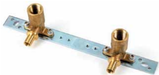
Рис. 36. Плоский двойной E-образный кронштейн с расстоянием 80 или 150 мм
