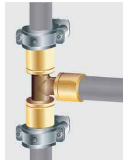
Рис. 26. Неподвижная опора с хомутами на тройнике
