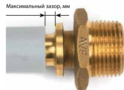
Рис. 10. Установка трубы с зазором в месте соединения
