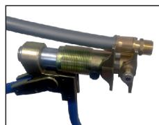
Держите инструмент за рукоятки или удерживайте уперев рукоять в корпус тела, другой рукой держите рукоятку инструмента. Начинайте сводить разводить рукоять до полного примыкания скользящего кольца с буртиком соединителя. При воздействии на рычаг, прессовые вилки
