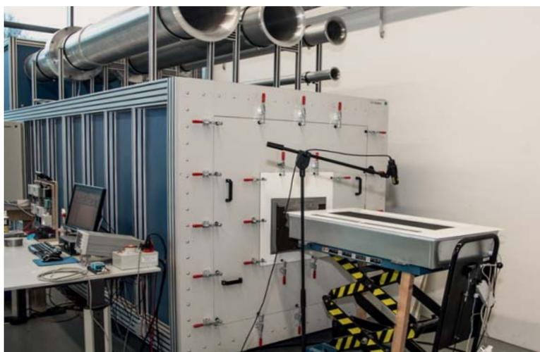
Испытательная камера для измерения производительности по воздуху; Kampmann F&E Center
